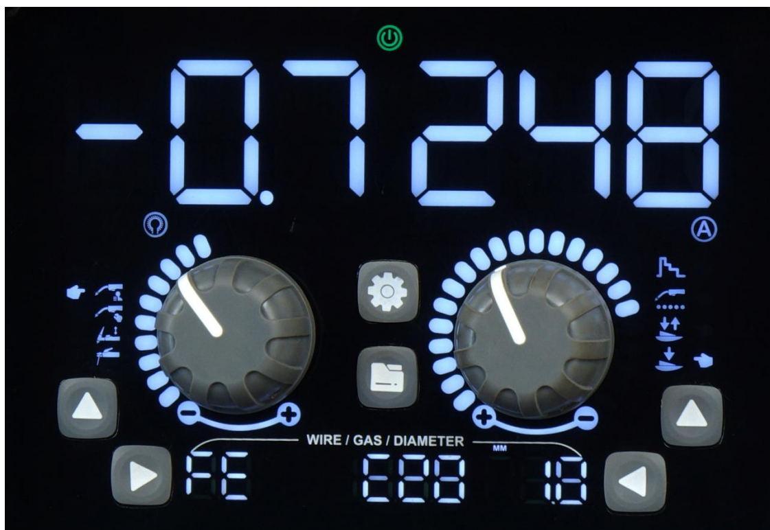
Rys. 19. Regulacja indukcyjności w panelu metody MIG/MAG synergiczny
