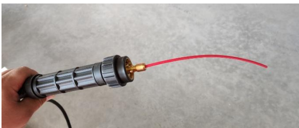
Rys. 11b. Teflonowa osłona drutu aluminium w uchwycie spawalniczym MIG
