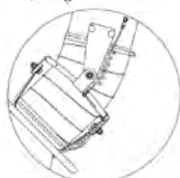
Przewód uziemiający przegubu ssawki
