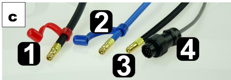
Rys. 4c. Wtyki uchwyty TIG, gdzie: 1 – wtyk wodny, do gniazda czerwonego 2 – wtyk wodny, do gniazda niebieskiego 3 – wtyk gazowy 4 – wtyk sterujący
