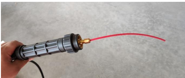
Rys. 11. Teflonowa osłona drutu aluminiumowego w uchwycie spawalniczym MIG
